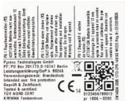
Abb. 1 Typenschild Rauchwarnmelder ohne Q-Label (Angaben können abweichen)
